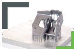
*Подключение к 3D-принтерам и автоматическое генерирование вспомогательных металлических 3-мерных структур:*
