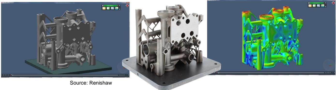
В первом релизе **Simufact Additive** сделан упор на моделирование процессов технологии расплавления материала в заранее сформированном слое (Powder Bed Fusion), включая процессы селективного лазерного плавления (Selective Laser Melting (SLM)), прямого лазерного спекания металлов (Direct Metal Laser Sintering (DMLS)), селективного лазерного плавления металлических порошковых материалов (LaserCUSING®), электронно-лучевого плавления (Electron Beam Melting (EBM)) и ряд других процессов.
