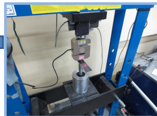
Определение поступательных жесткостей сайлентблоков подвески
