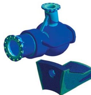
Подмоделирование экономит время и позволяет получить точные результаты на подробной модели исследуемой части конструкции
