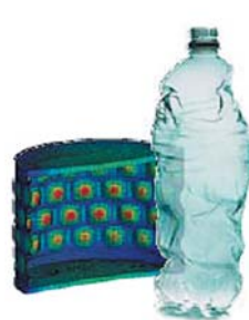
Нелинейный анализ потери устойчивости гибких структур, нагруженных внутренним давлением
