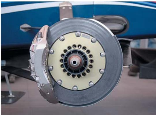
Дисковый тормоз из композиционного материала на основе углеродных волокон
