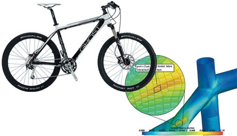
Ученые из Института легких конструкций Технологического университета г. Чемниц (Германия) рассчитали напряжения для велосипедной рамы, изготовленной из углепластика по заказу GHOST Bikes GmbH. ANSYS Composite PrepPost использовался для анализа разрушения этой конструкции.
